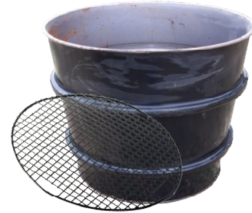
Посуда за мокру деактивацију употребљених препарата у тувек амбалажи са металном мрежастом решетком за потапање препарата. 06 03 16 – безопасан отпад
