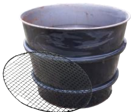
Posuda za mokru deaktivaciju upotrebljenih preparata u tyvek ambalaži sa metalnom mrežastom rešetkom za potapanje preparata.
