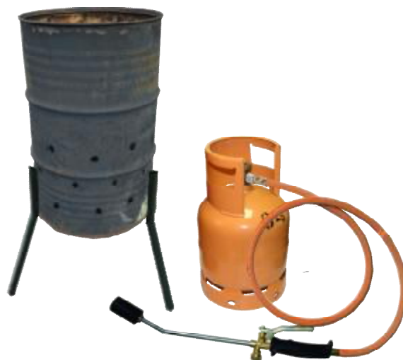
Mesto za spaljivanje deaktiviranih preparata u tyvek ambalaži. Metalni vertikalni bubanj (kao bure od 200 lit.) sa rešetkastim dnom za uvođenje brenera za spaljivanje.
